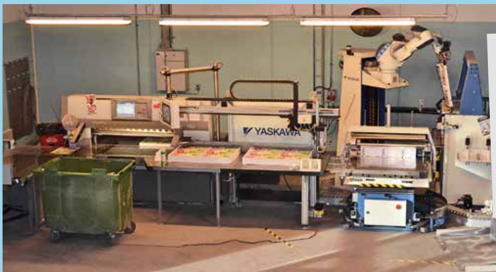
Hele skærelinjen som den tager sig ud med påfyldning til højre, robot, rystebord, transportbuffer, skæring og aflægning helt til venstre.
